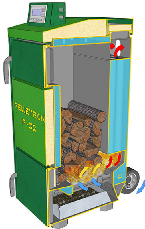
Рис. 2 - Принцип действия котла Profi
