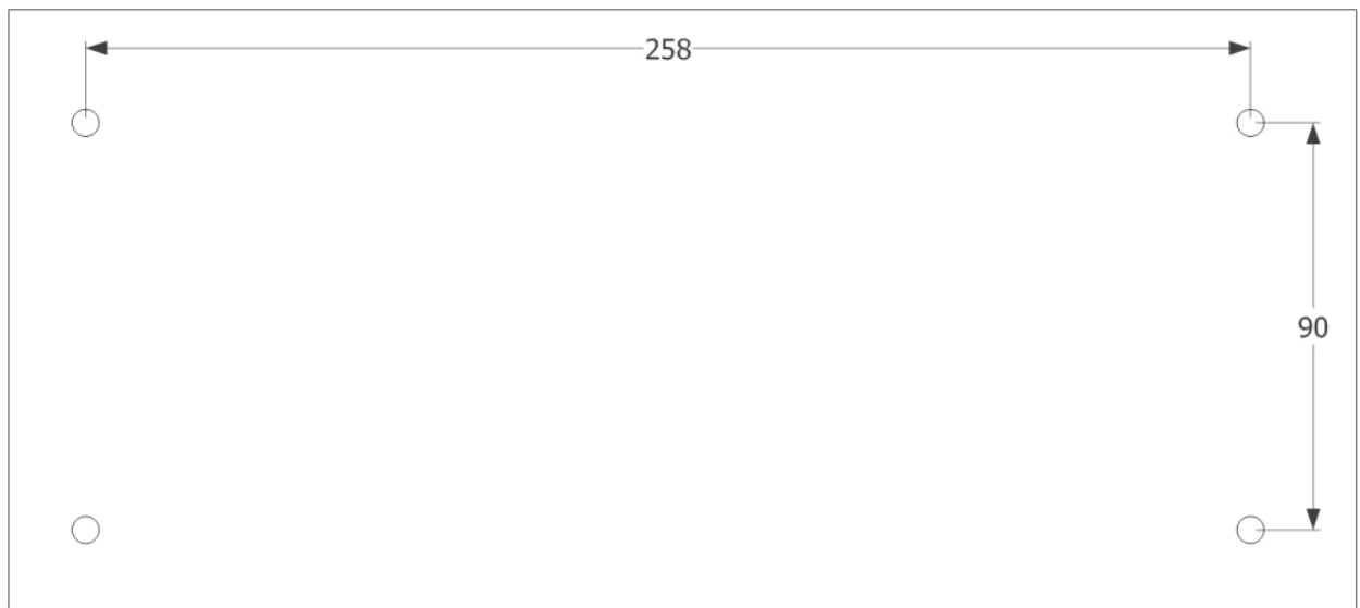
Рис. 2 - Схема крепежных отверстий БУ ТЭН
