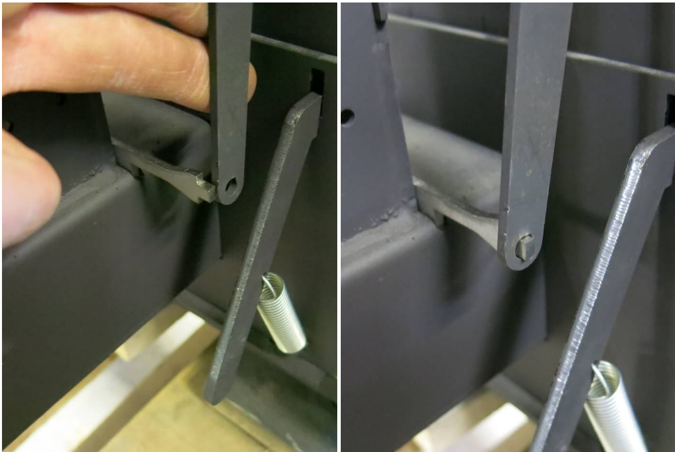
Рис. 25 - Установка тяг регулятора
