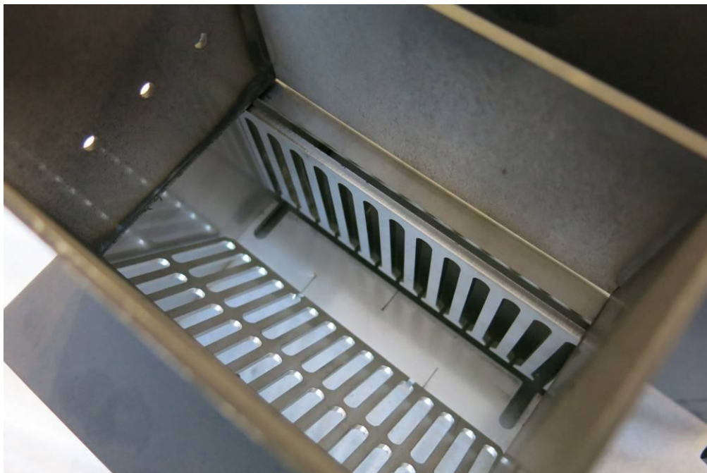
Рис. 21 - Продолжение установка корзины в горелку
