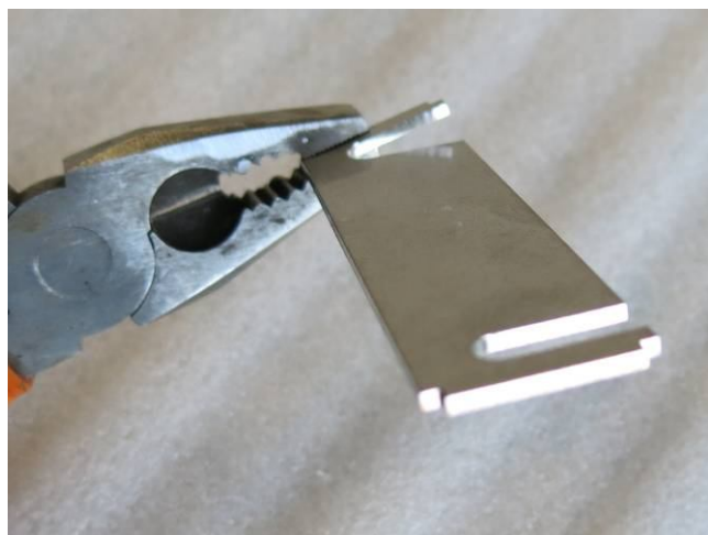
Рис. 34 - Отгибание краев полки
